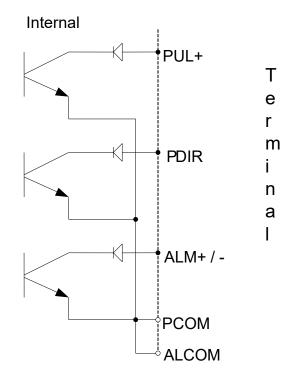
Fig 2.5 (d) Example of transistor open collector
